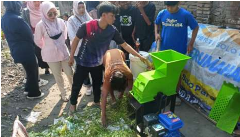
Gambar 1. Perajangan sampah organik dengan menggunakan mesin perajang.
